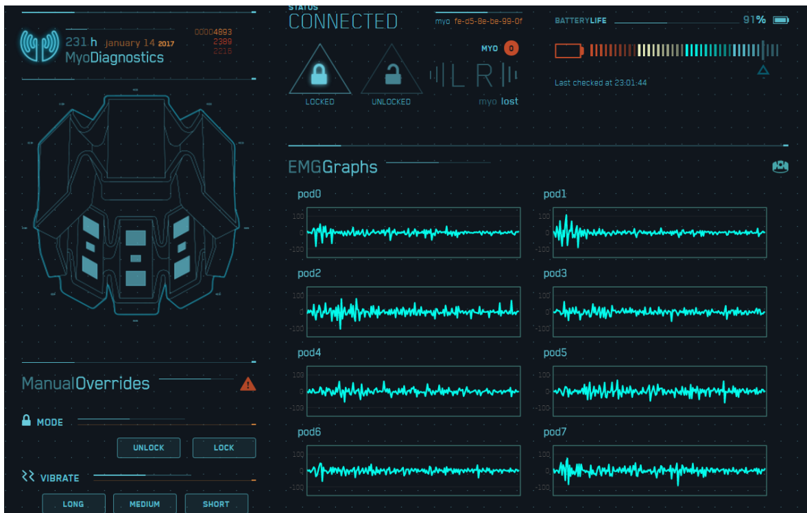
Figura 12. Lectura de los 8 sensores EMG graficando el gesto de la mano.
