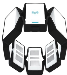
Figura 4. Brazalete MYO que contiene la unidad de medición inercial, los sensores de grado médico, y el sistema Bluetooth 4.0 Smart.
