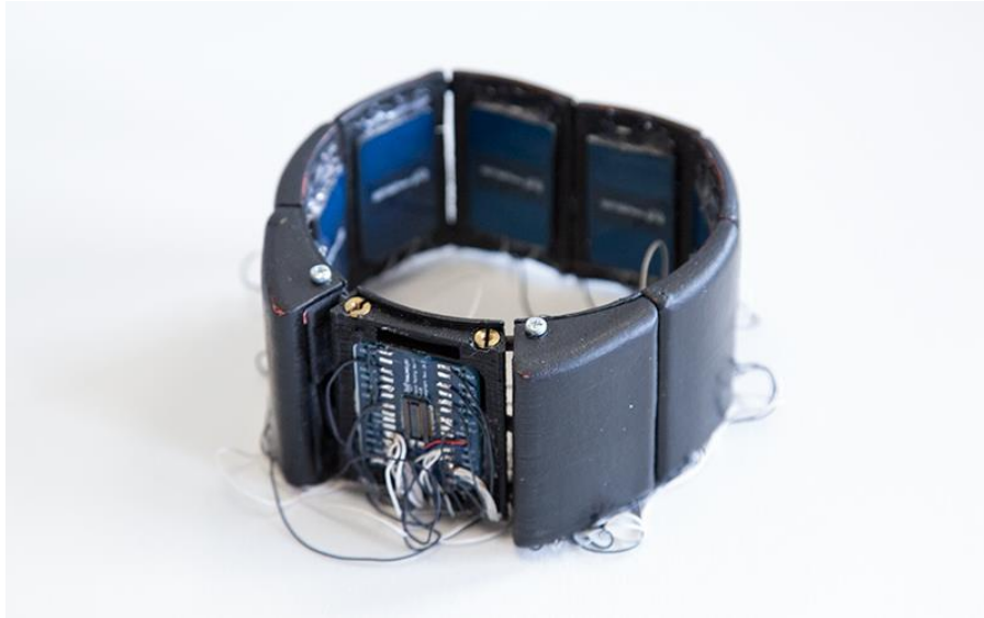
Figura 6. Conexiones internas del brazalete MYO.
