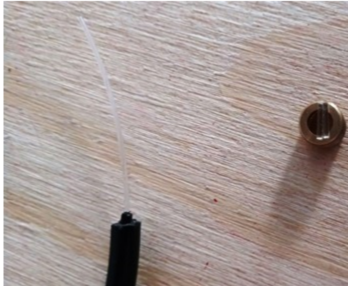
Figura 3.13: Construcción del difusor con fibra óptica
