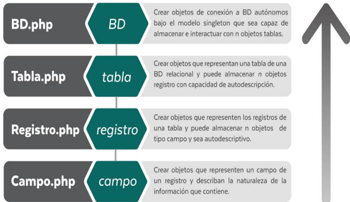
Figura 4.4: Modelo de factorización Down-Top aplicado en la implementación del BackEnd
