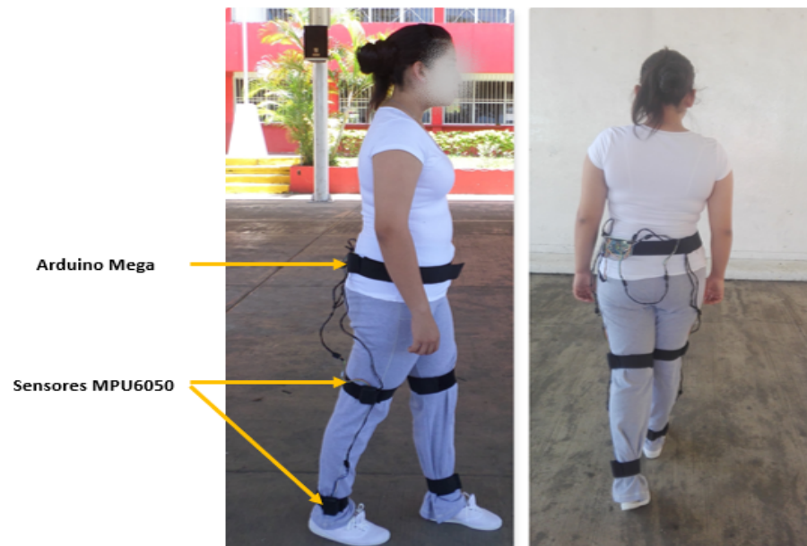
Figura 5.3: Colocación de la red sensores.
