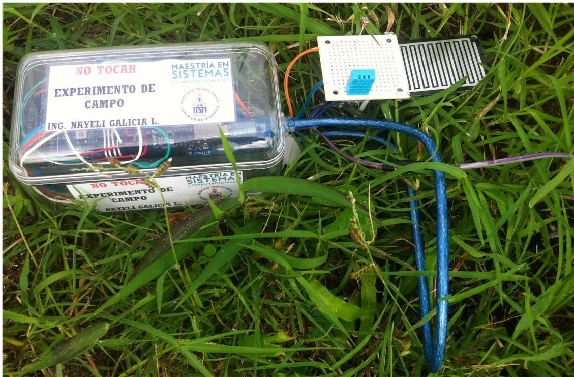
Figura 4.5: Mini-estación ensamblada.
